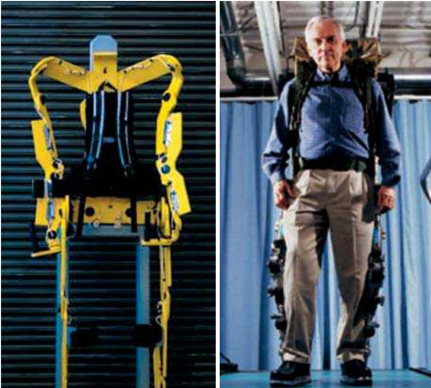
Il BLEEX, un robot che fornisce un aiuto a persone che debbano trasportare grossi pesi per lunghe distanze oppure a persone che abbiano delle disabilità motorie.
