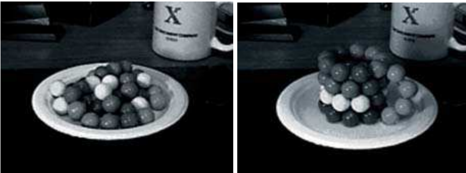
Sistema di auto-costruzione basato su piccole sfere che si aggregano a dar forma ad una tazza.
