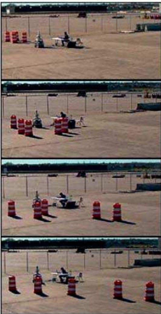
Robot sparti-traffico utilizzati negli USA per cambiare il numero di corsie sulle strade a seconda dei flussi di traffico.
